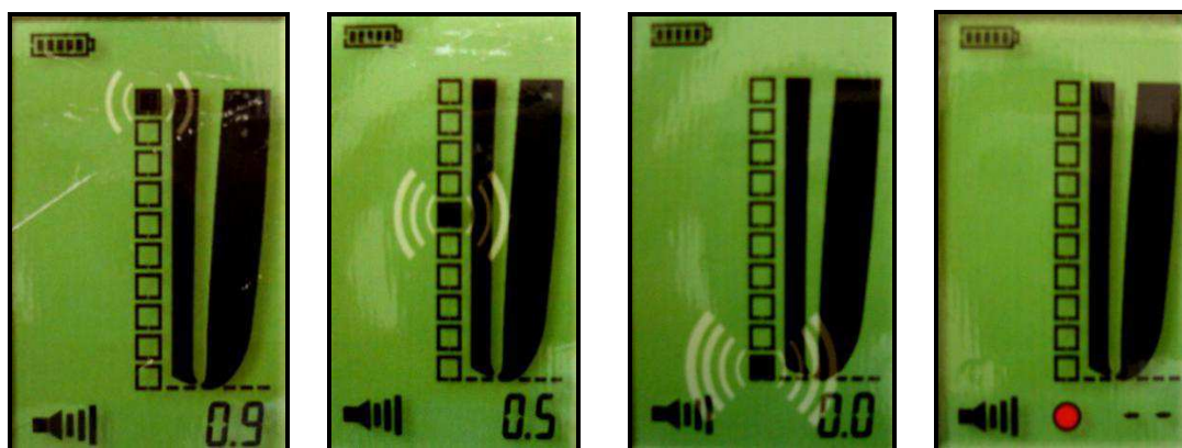
Fig. 11. Pantalla del Localizador Electrónico Apical Propex durante su funcionamiento.
