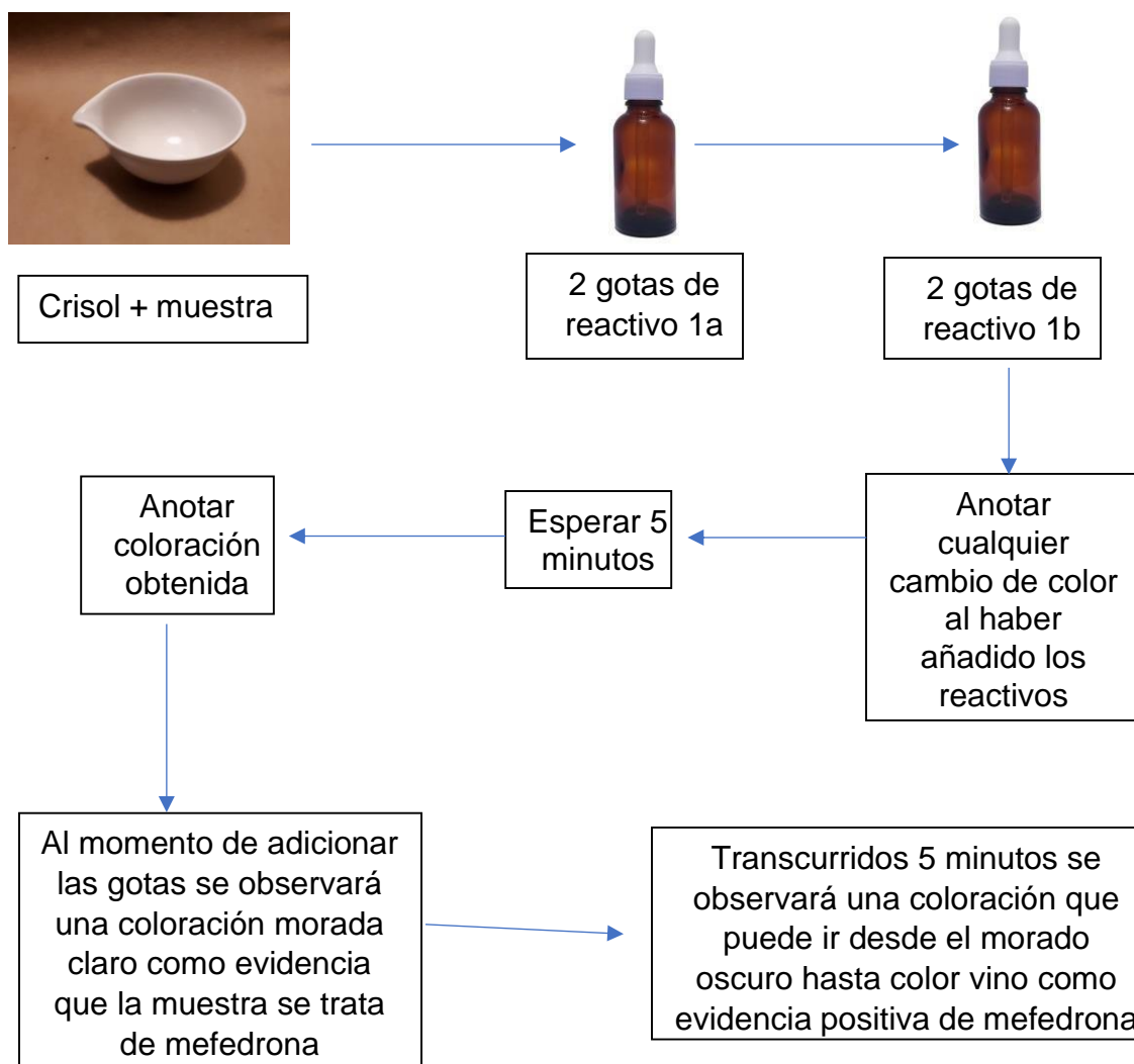
Figura 7. Procedimiento modificado de la prueba de Zimmerman
