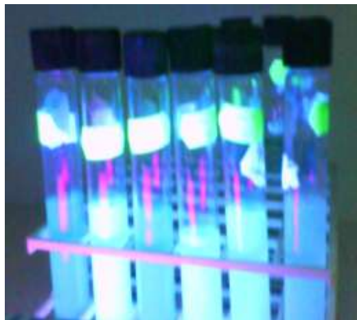
Figura N° 23. Prueba presuntiva para Escherichia coli por medio de la lámpara de luz UV, la fluorescencia producida en los tubos indica posible presencia de Escherichia coli .
