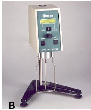
Fig. 11: viscosímetro de Brookfield (A: análogo, B: digital, C: pines para viscosímetro).
