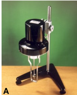
Fig. 11: viscosímetro de Brookfield (A: análogo, B: digital, C: pines para viscosímetro).
